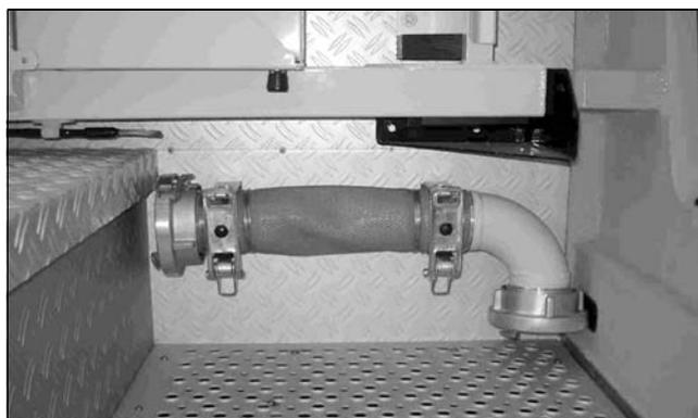
[I 68] Verbindungsschlauch im Geräteraum (A)
