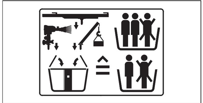
[137] Warnschild im Korb: Korbbelastung bei Benutzung der Multifunktionssäule um eine Person reduzieren und Korbtüren geschlossen halten
